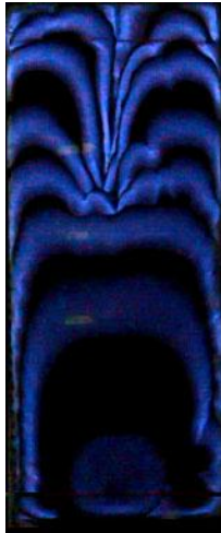
Gambar 2. Pola Rambat Api Campuran Gas Metana-Udara dan N 2 10%
