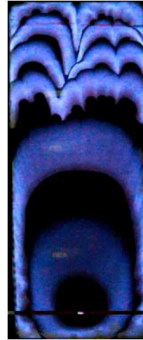
Gambar 3. Pola Rambat Api Campuran Gas Metana-Udara dan N 2 20%
