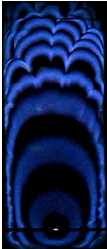
Gambar 5. Pola Rambat Api Campuran Gas Metana-Udara dan N 2 40%
