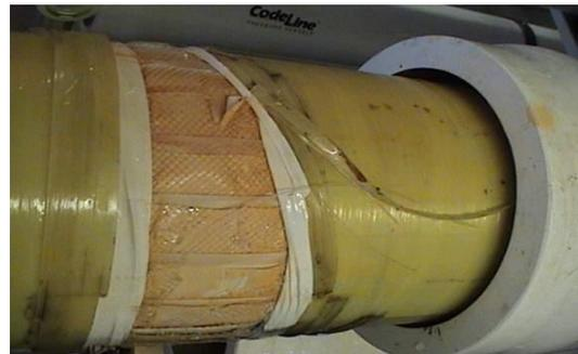
Gambar 7. Membrane *overpressure*
