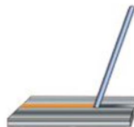
Gambar 2. Posisi pengelasan 1G/PA flat position
