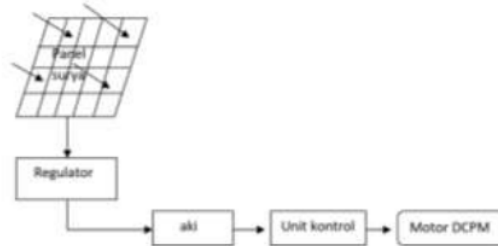
Gambar 7 : Perancangan Kelistrikan dan komponen utama
