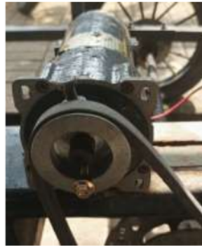
Gambar 11 : Posisi pemasangan belt ke beban
