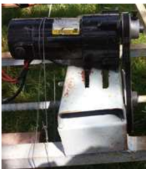
Gambar 9 : Motor sudah terhubung dengan belt ke beban
