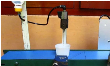
Gambar 4. Gelas air minum dalam proses pengisian
