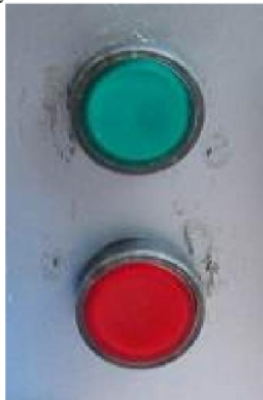
Gambar 2. Push button Start dan stop
