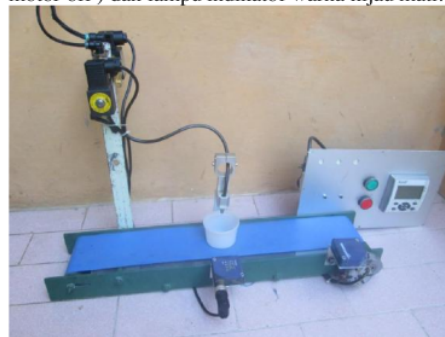
Gambar 3. Gelas air minum berhenti di tempat pengisian
