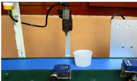
Gambar 5. Gelas yang sudah diisi berjalan lagi untuk proses selanjutnya
