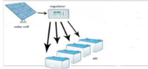
Gambar 2. Skema Pengisian Aki Untuk 4 Buah Aki
