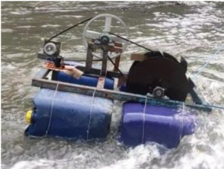
Gambar 13. Proses pengapungan pembangkit pikohidro menggunakan dua tali.
