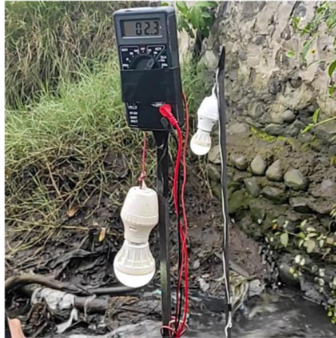
Gambar 8. Proses Pengukuran Tegangan di Muara saat Air Laut Surut Tabel 2. Hasil Pengukuran
