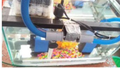
Gambar 7 Rangkaian Generator Turbin Air Mini
