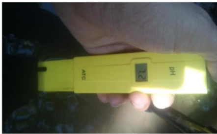
Gambar 3.15 pH meter digital di Tambak
