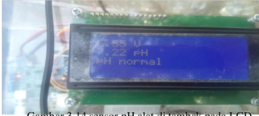
Gambar 3.14 sensor pH alat di tambak pada LCD
