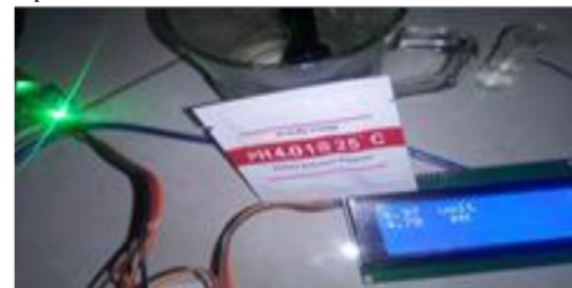
Gambar 3.2 Hasil Pengujian degan pH buffer 4.01
