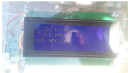
Gambar 3.20 sensor pH alat di tambak pada LCD
