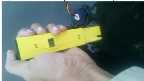
Gambar 3.27 pH meter digital di Tambak
