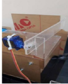
■ Gambar 13 Pintu servo pada bak penimbang buah
