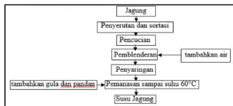
Gambar 1. Proses pembuatan susu jagung
