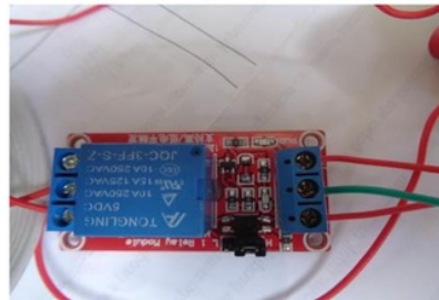
Gambar 12. Tampilan koneksi kabel pada relay
