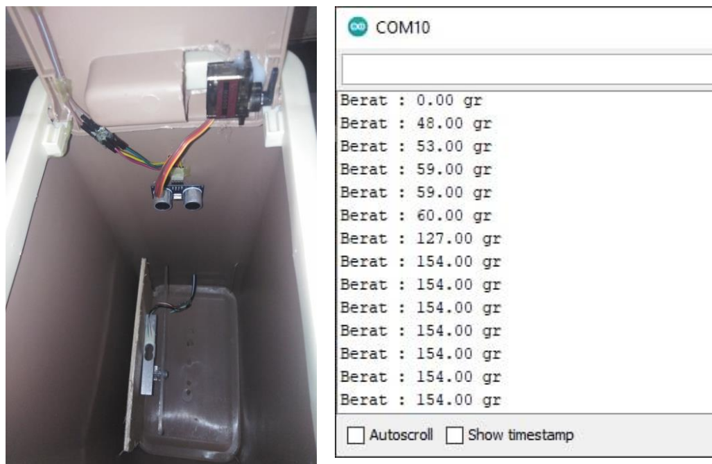
Gambar 4.8 Letak dan Hasil Pembacaan Sensor Berat
