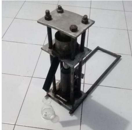
Gambar 3.1. Alat press hidrolik
