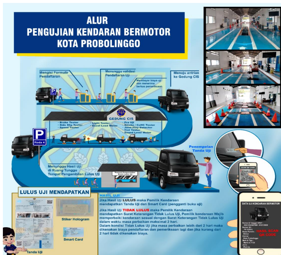
Gambar 10 : Alur Pelayanan UPT Pengujian Kendaraan Bermotor Kota Probolinggo
