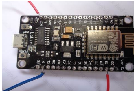
Gambar 11. Tampilan koneksi kabel pada board arduino
