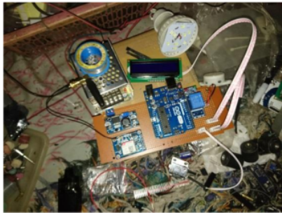
Gambar 12. Proses perakitan selenoid doorlock ke arduino
