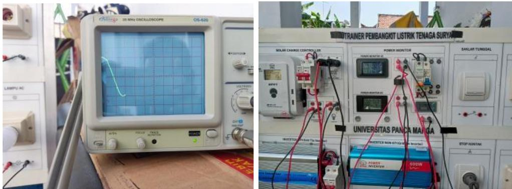
Gambar 4.15 Pengambilan data untuk beban R, L dan C
