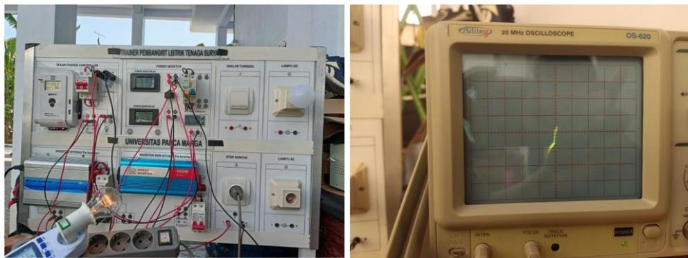
Gambar 4.16 Pengambilan data untuk beban RL, LC dan RC
