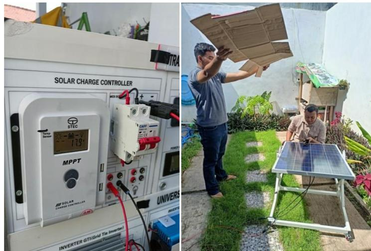
Gambar 4.12 Proses pengambilan data pengujian MPPT
