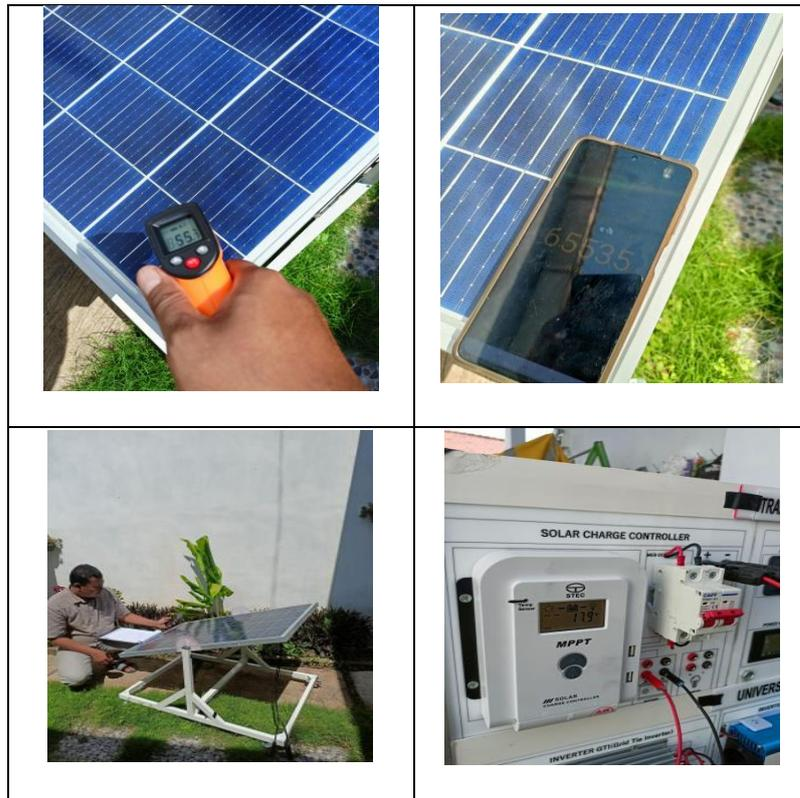
Gambar 4.11 Proses pengambilan data pengujian panel surya
