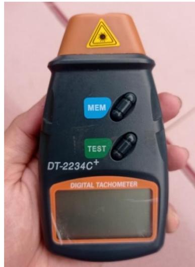
Gambar 4.20 Tachometer Digital untuk Mengukur Putaran atau RPM
