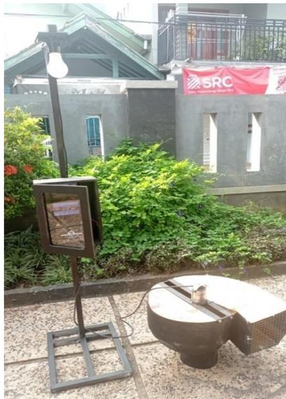
Gambar 4.10 *Prototype* PLTMH yang telah sesuai dengan Desain
