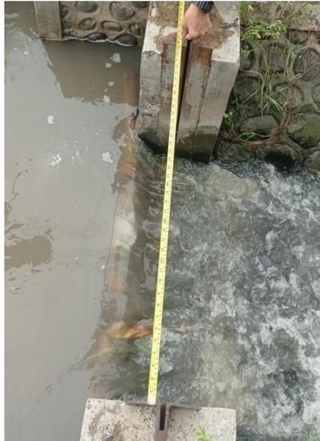
Gambar 4.13 Pengukuran Lebar sungai menggunakan meteran
