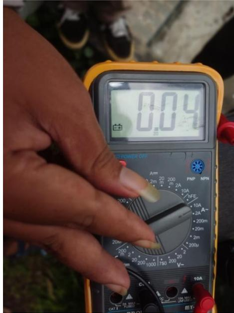
Gambar 4.19 Pengukuran Arus listrik pada keluaran Inverter
