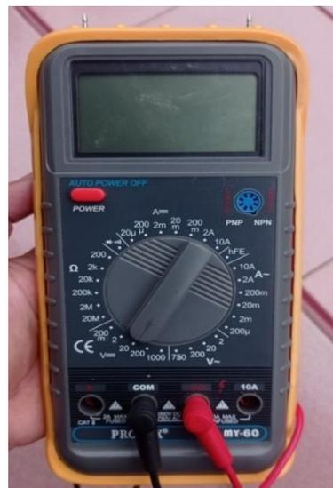
Gambar 4.21 Multimeter Digital untuk Mengukur Tegangan dan Arus
