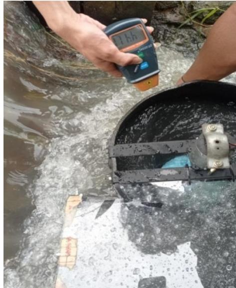
Gambar 4.14 Proses Pengukuran RPM Menggunakan Tachometer Digital
