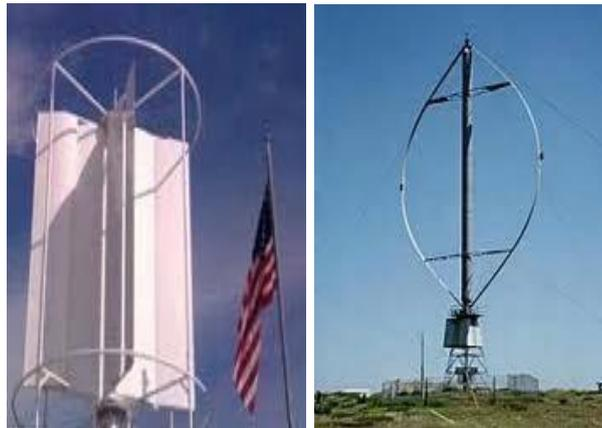
**Gambar 2.6 Turbin Angin Sumbu Vertikal**
