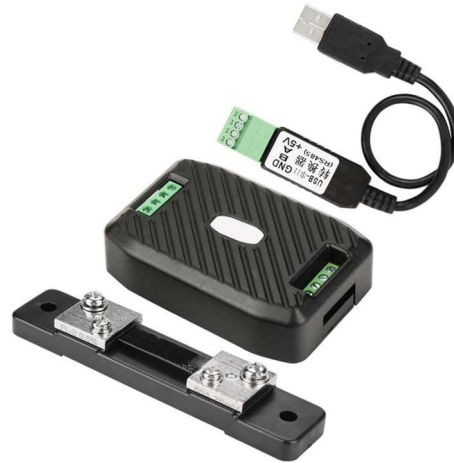
Gambar 4.2 Modul sensor Arus dan tegangan PZEM017
