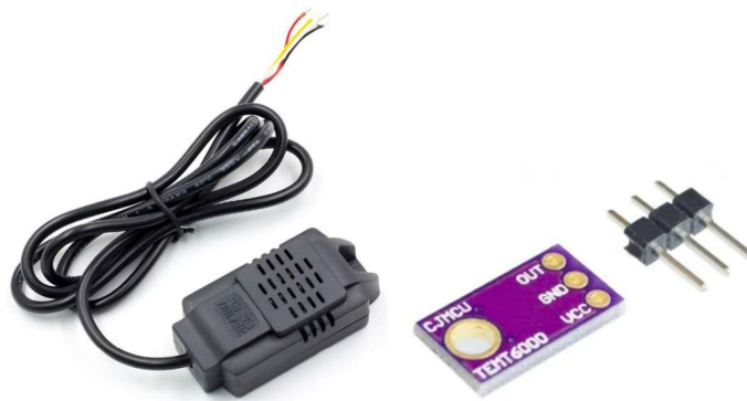
Gambar 4.3 Modul sensor Suhu dan Kelembaban SHT20 dan Sensor TEMT6000
