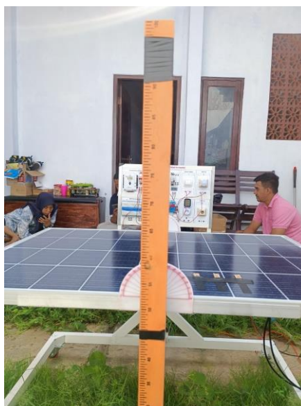
Gambar 3.5 Posisi Tiang Pembentuk Bayangan
