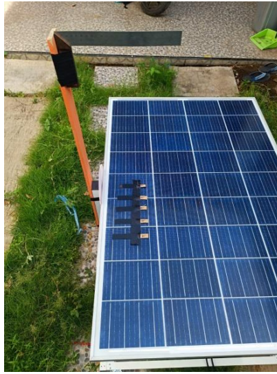
Gambar 3.6 Posisi Bayangan Dari Variasi Beberapa Sudut Pengukuran
