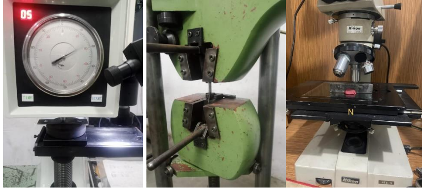
Gambar 3. 11 Proses uji tarik, kekerasan dan uji mikrostruktur
