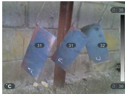
Gambar 3. 4 Pendinginan lambat media udara
