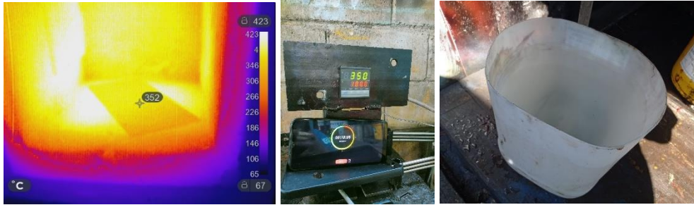
Gambar 3. 7 Proses partitioning suhu 350°C selama 10,15 dan 20 menit
