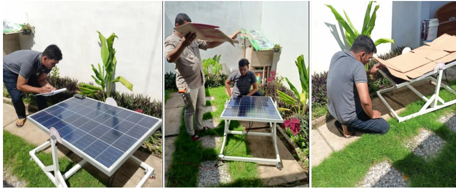
Gambar 4.10 Pengambilan Data MPPT dengan Perubahan Nilai Lumen
