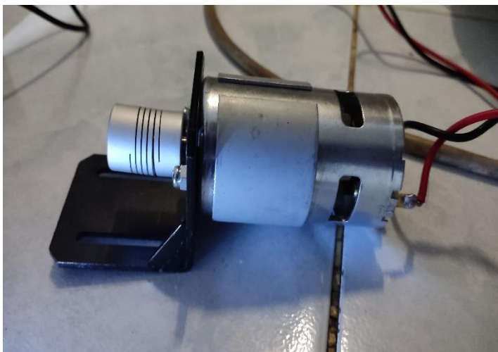
Gambar 4.10 Motor DC sebagai Alat Penggerak Conveyor
