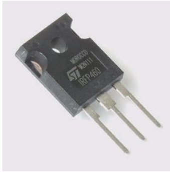
Gambar 3.9 Bentuk fisik Mosfet
