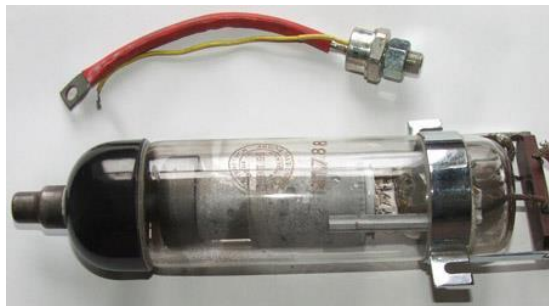
Gambar 2.2 Perbandingan bentuk fisik SCR dengan Thyatron ( http://www.tuopeek.com/image2/thyatron.jpg )
