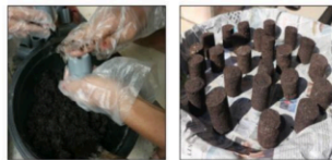
Gambar 10. Proses pencetakan dan penjemuran briket
