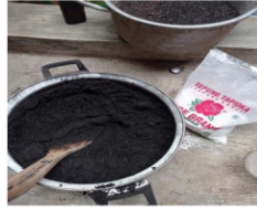
1 Gambar 9. Proses Pencampuran arang baglog dengan tepung perekat
