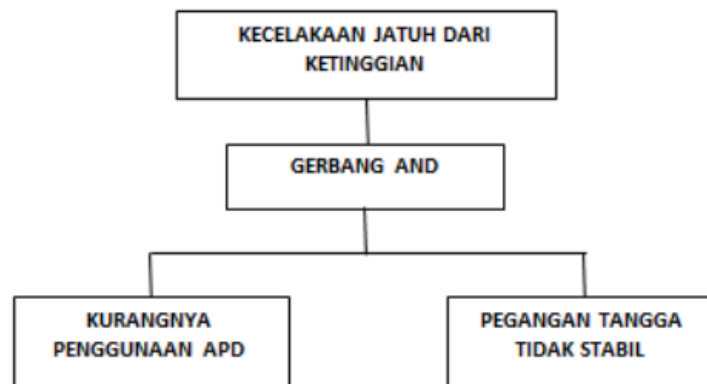
Gambar 6.2 Diagram pohon kesalahan hubungan sebab-akibat menggunakan gerbang logika
