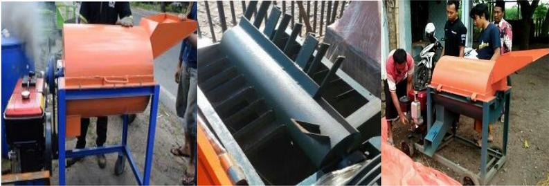
Gambar 8. Tampilan Mesin Pencacah Jerami
